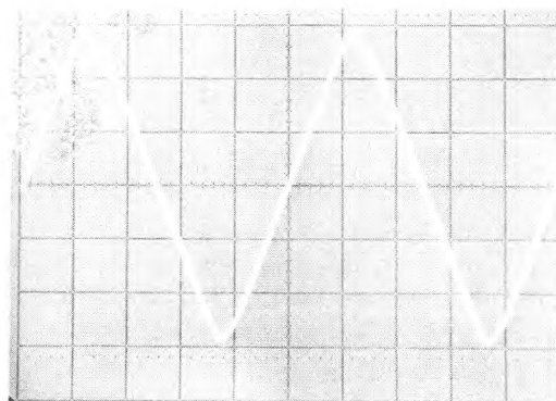
b. 10kHz Triangular Wave Scales: X 20 \mu s/div., Y 500mV/div.
