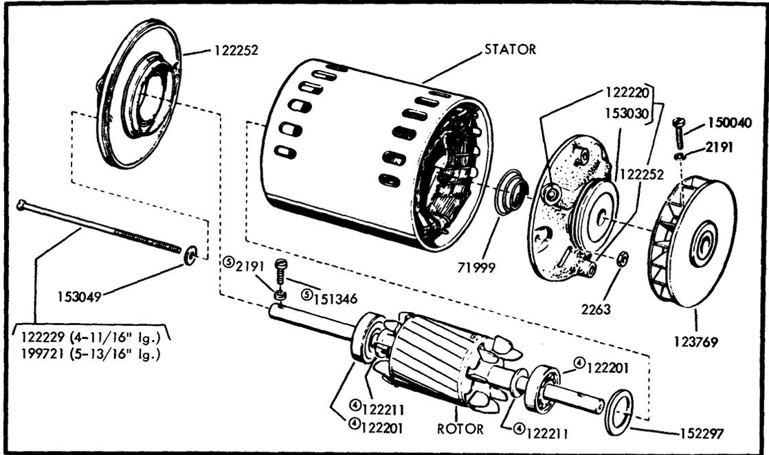
SYNCHRONOUS MOTOR ASSEMBLY - STANDARD OR HEAVY DUTY
