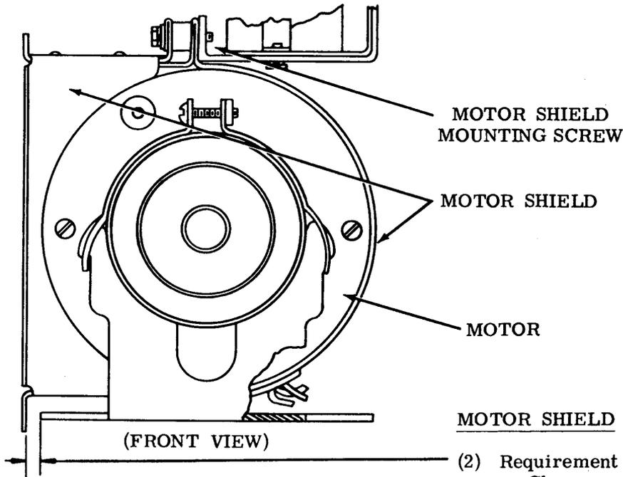
MOTOR SHIELD (IF SO EQUIPPED)
